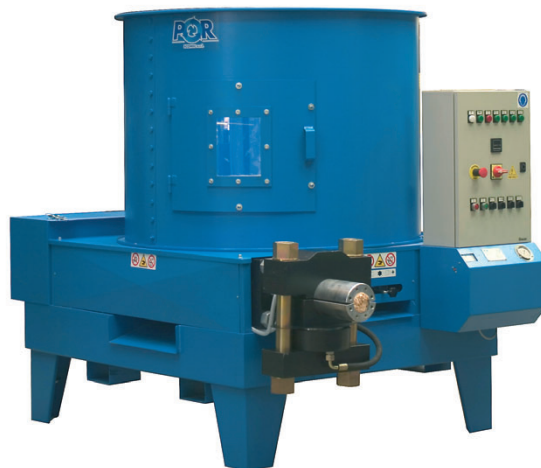
Seria Oscar to brykociarki przemysłowe. Produkują brykiet o rozmiarach 70 x 80 mm. Duża średnica cylindra umożliwia zgniot o sile ponad 1000 kg/cm 2 . Wydajność – 1623 m 3 /godz.
